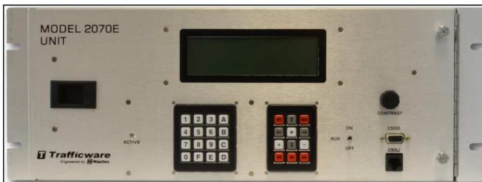
2070 ATC with Linux 2070-1C module
